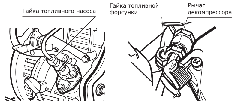
Рис. 8,9 Удаление воздуха из топливной системы двигателя
